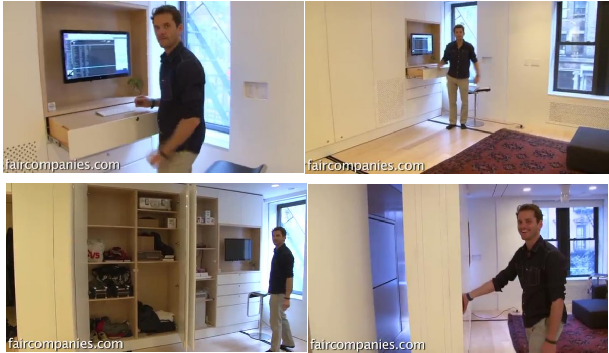
Şekil 9. Zemine bağlı hareket edebilir bölücü duvar modülünün farklı fonksiyonlara cevap vermesi ve mekân tanımlaması (Dirsken, 2012)
